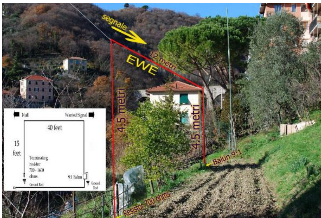
Η EWE τοποθετημένη.
